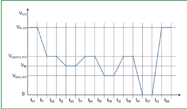
EHV-03 高压欠压范围内的高压电压曲线
