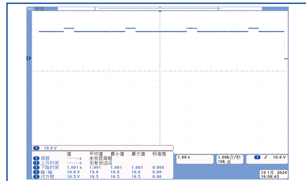
12V电力系统实测图
